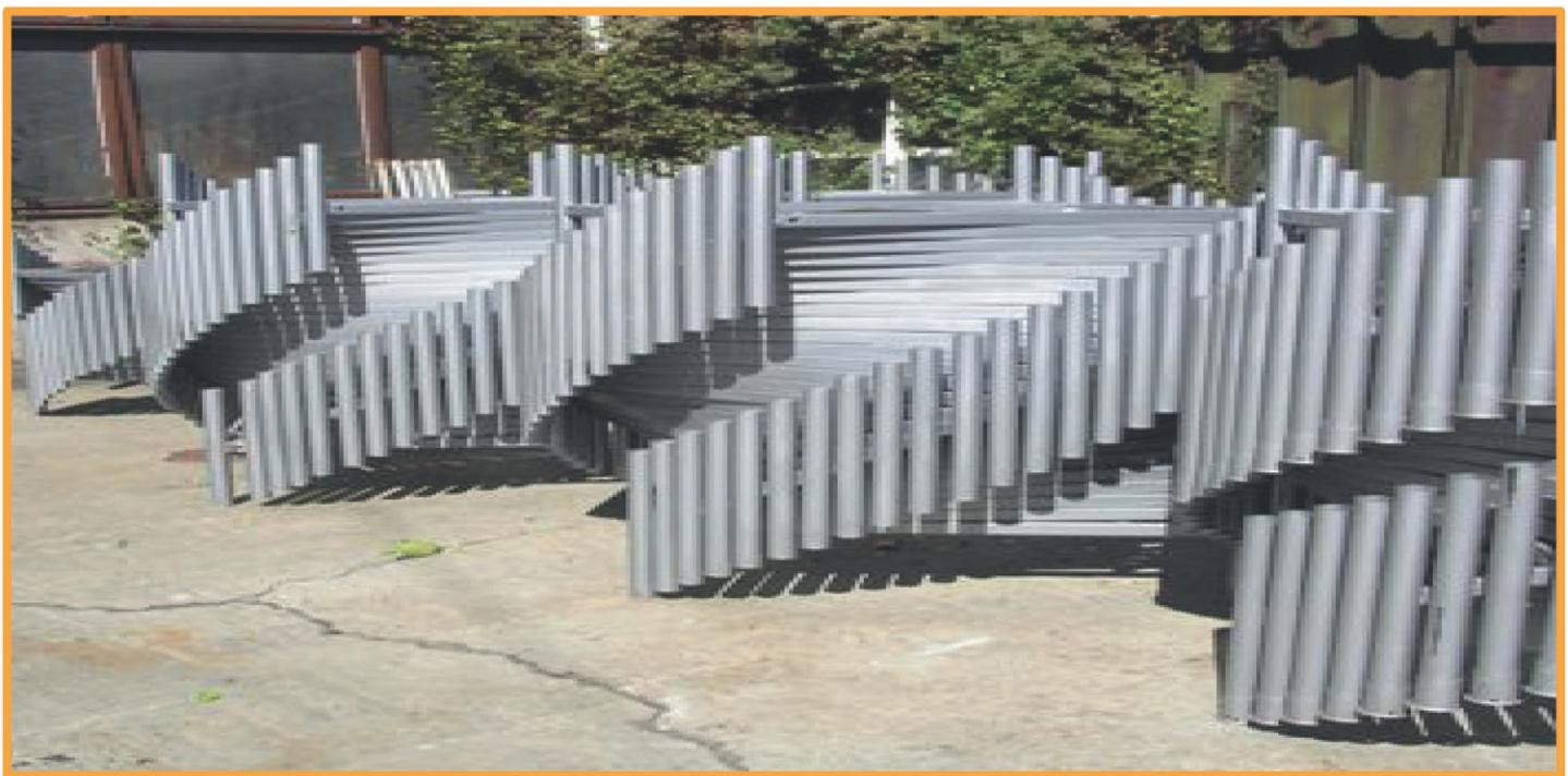
İstif iskelesi, adından da anlaşıldığı gibi karşılıklı istiflenerek üst üste kolayca yerleştirilip kurulduğu gibi, istendiği takdirde yan çapraz bağlantı elemanı da kullanılarak tek parça kullanılabılır. Manuel montaj ve demontajının kolaylığı haricinde sistem, tek parça kullanıldığındá kaplanmış olduğu yatay alanlar yaklaşık olarak 5/6 m<sup>2</sup> seviyelerdedir.
