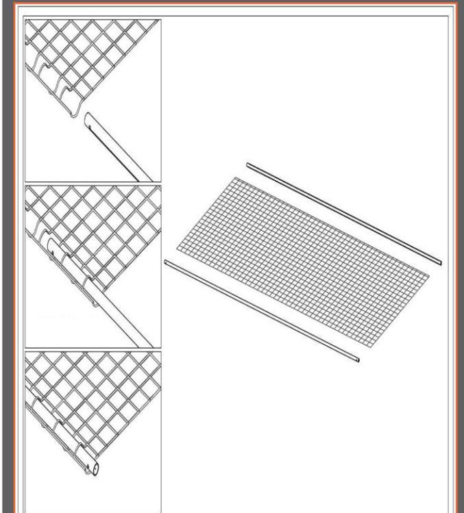
**2** Malzeme montajına güvenlik ağının güvenlik borusu ile birbirine eklenmesiyle başlanılır. Bu aşamada yatay ağ boruları güvenlik ağının içinden geçirilir. Güvenlik ağının gergin durması için güvenlik ağı yatay ağ borularının uçlarında bulunan deliklere sağlam bir ip vasıtasyyla bağlanır.
