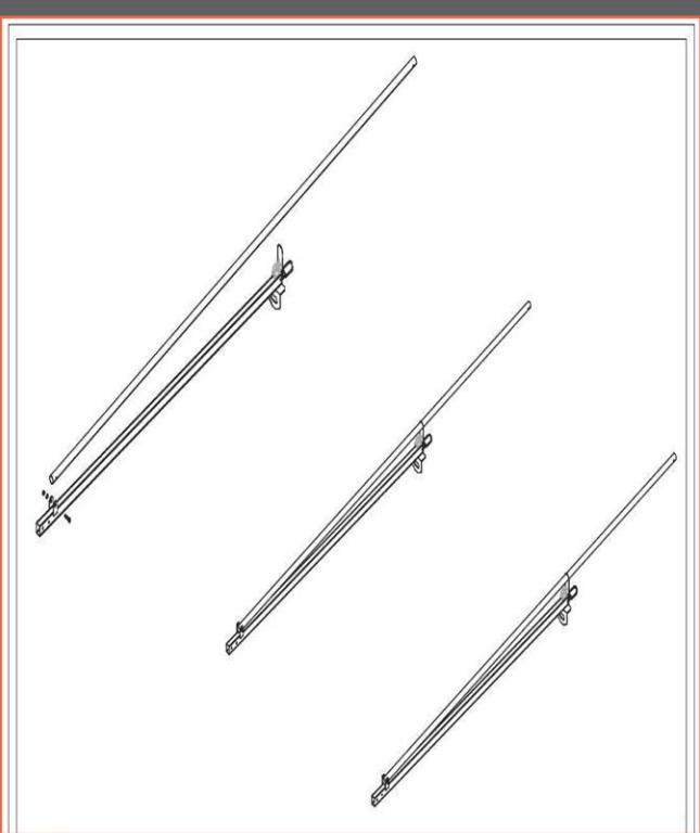
**3** Dikey taşıyıcı ve M16/100 civata somun pul ile birlleştirilir. Montajı yapılan elementler yatay ağ borularının bağlanması için yan yana getirilir.
