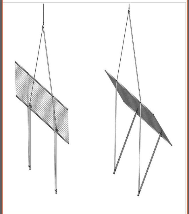
**6** Güvenlik platformları kat betonuna monte edilecekleri yere vinç yardımıyla açık ve kapalı olarak taşınır. Kapalı taşıma: Dikey taşıyıcıdan vinç askılarından bağlanarak taşımadır. Açık taşıma: Dijagonal taşıyıcı ile yatay ağ borusunun hareketli kelepçe ile birleştiği yerden vince bağlanarak taşımadır.
