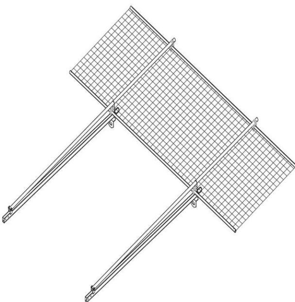
**5** Güvenlik ağıının bağlı olduğu yatay ağ boruları dijagonal taşıyıcıya hareketli kelepçe ile, dikey taşıyıcıya da üzerinde bulunan kelepçe ile bağlanır.
