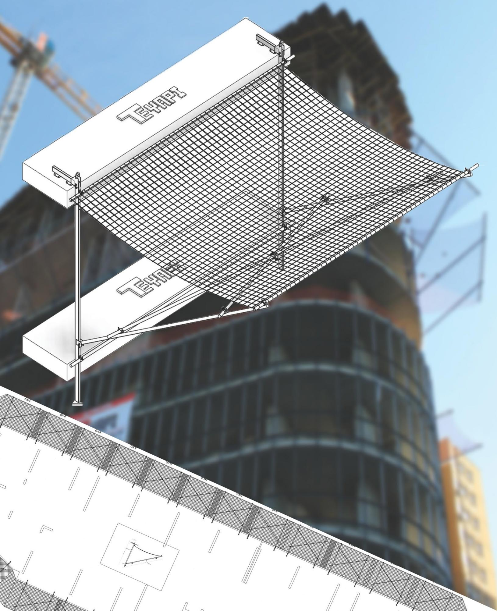
Bina çevresi güvenlik sistemleri, olası malzeme ve insan düşmelerine karşı güvenlik amacı ile kullanılmaktadır. Uygulaması yapılan güvenlik sistemlerin amacı üst kotlarda devam eden yapı imalatı süresince, düşme sonucu oluşacak iş kazalarını minimuma indirmektir.
