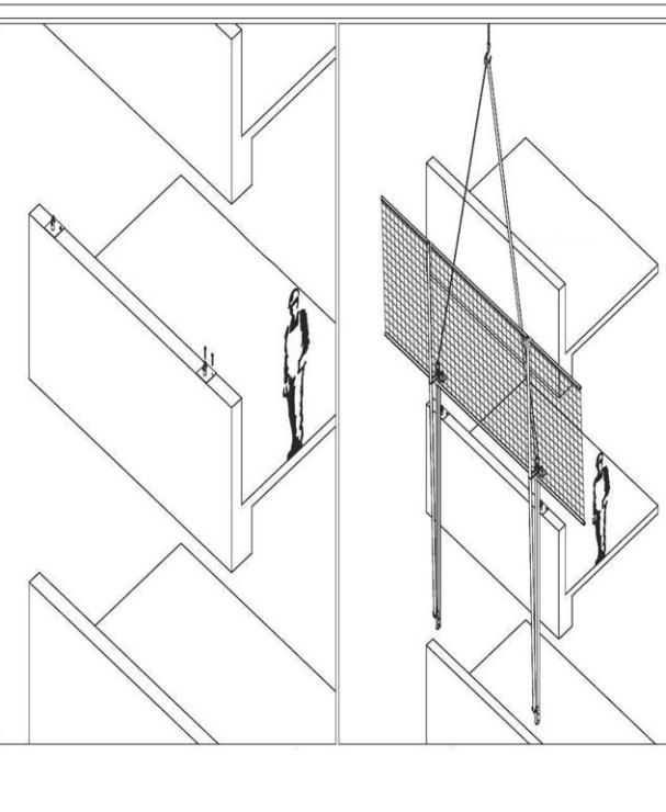
**7** Montaj adaptörü D16 / 50 delikli pim M12 / 120 beton vidası ile parapete sabitlenir. Vinç ile taşınan güvenlik platformu montaj adaptöründeki boruya oturtulur. D16 / 50 pim firkete ile güvenlige alınır.
